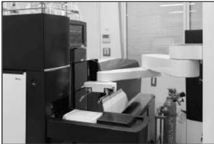
世界初となるロボット対応液体クロマトグラフ。スカラ型ロボットでLCへのプレートの設置、交換を自動化している【クリックで拡大】 出所：島津製作所
