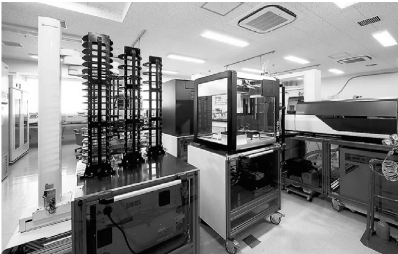
神戸大学統合研究拠点内のバイオフィアウンドリー実験室に設置した自律型実験システム「Autonomous Lab」プロトタイプ
